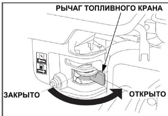
Рис. 7 Рычаг топливного крана
