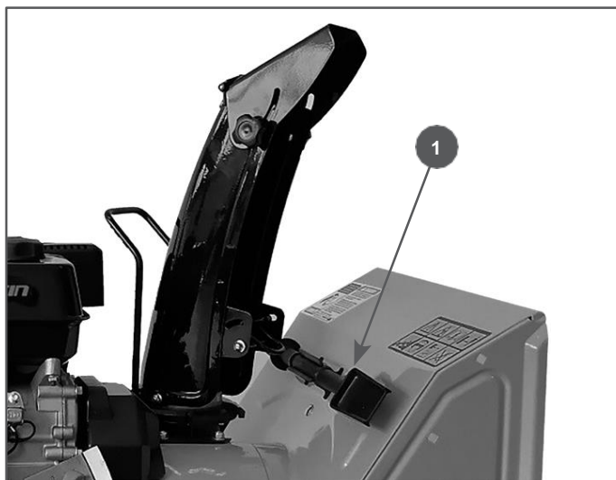
Рис. 11 Расположение лопатки для очистки 1. Лопатка для очистки
