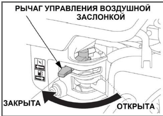
Рис. 6 Рычаг управления воздушной заслонкой
