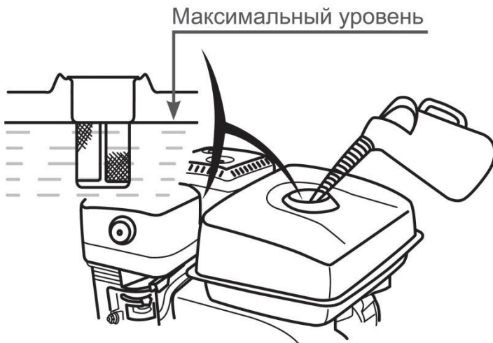
Рис. 4 Максимальный уровень топлива в топливном баке
